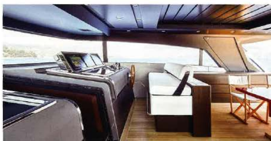
Luftige Brücke: Den einzigen Steuerstand an Bord brachte das Designteam um Piero Lissoni auf der Flybridge unter. Die Fenster lassen sich hydraulisch bewegen.
